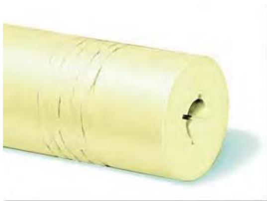
(1) Risse auf der Oberfläche weisen auf eine Beschädigung der Gesamtstruktur hin.
