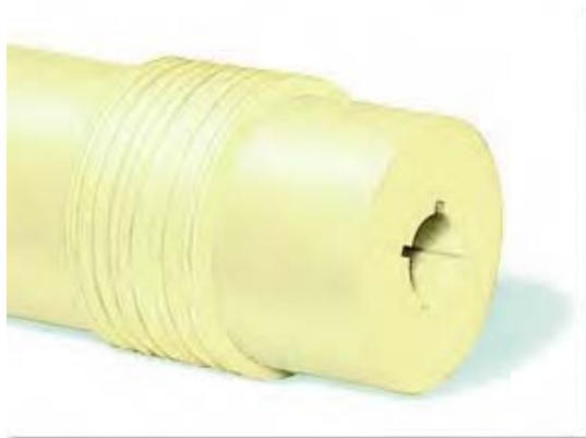
(3) Ausgestochene Stellen werden durch neues Material ersetzt.
