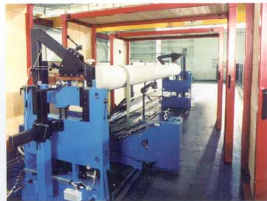
Dynamisches Auswuchten von Walzen in einer Schenk-Anlage
