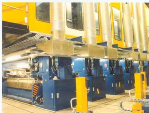
Cerutti Druckwerke mit MITEX Presseuren - Tiefdruckrotation 3600 mm DB
