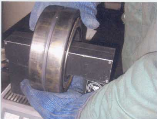
Vorbereitung zur Lagermontage
