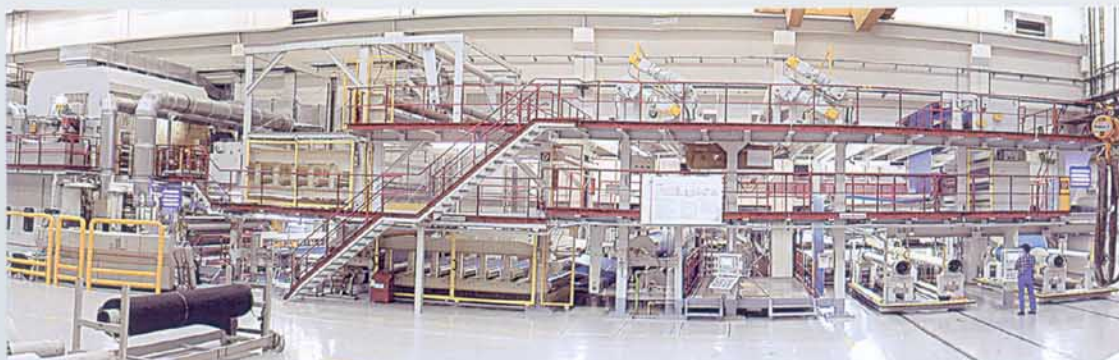
Siegling Hannover - Weltgrößter Kunststoffkalander zur Herstellung von Transportbändern
