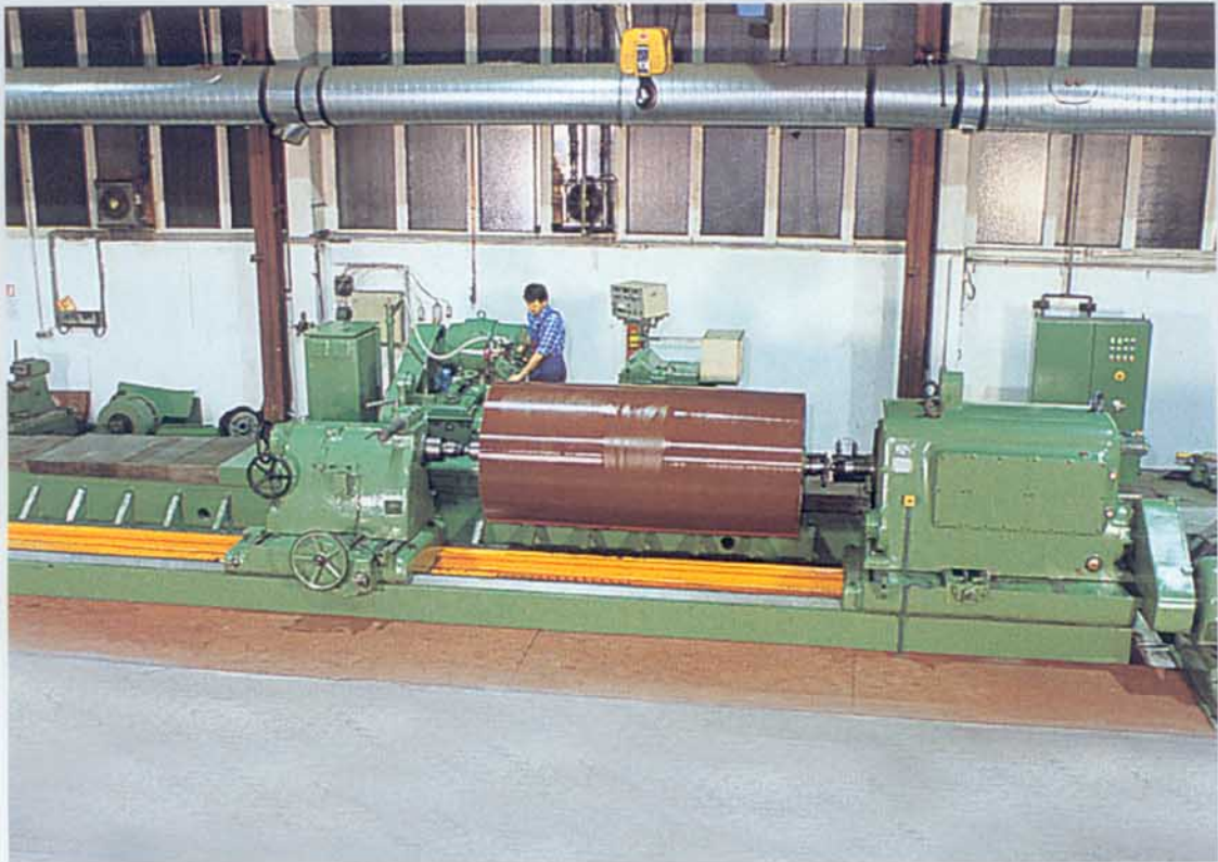
Schwere Walzenschleifmaschine für Präzisionsschliffe
